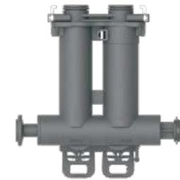
Posición de derivación: el agua no entra en la válvula.
